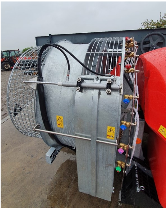
Bild 3: Die Gebläseabdeckung wird hydraulisch verschoben und verschließt den Gebläseauslass auf der rechten Seite.
